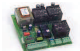
Scheda elettronica 884 T (incorporata nell'automatismo)
